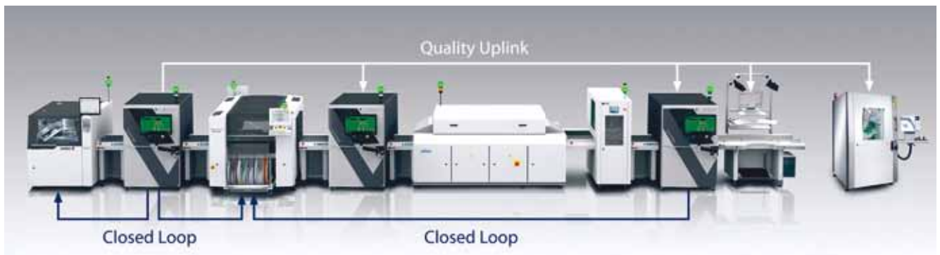
Prüflinie in der SMT-Fertigung
